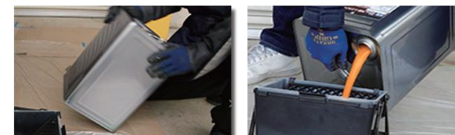
ご使用前には缶を前後左右に振る、攪拌棒でかき混ぜる等、必ずよくかき混ぜて塗料を別容器に移してから塗装を始めてください。
